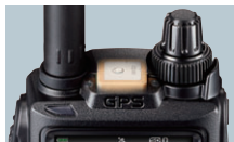
Position der hoch präzisen GPS-Antenne
