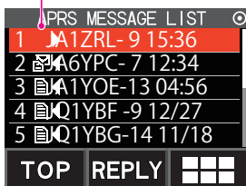
Schermata APRS MESSAGE LIST (quando il numero di trasmissioni rimaste è quattro)
