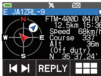
Anzeigenbeispiel bei Empfang eines APRS-Signals
